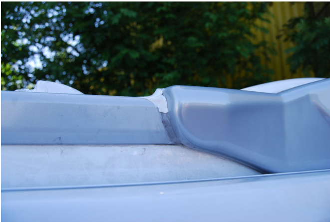
Typische Delle im Alublech mit Muschelstruktur Reparatur mit HBC-Methode
