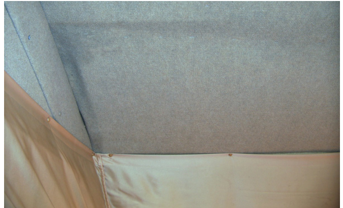
Wasserränder am Dachhimmel, sich auflösende Dachverkleidungen, Rostwasser aus Haltestiften und Tapetenverfärbungen von verschiedenen Herstellern.
