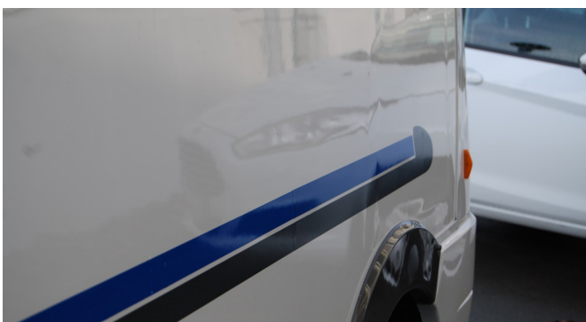
Durch Feuchtigkeit aufgequollene Alkovenseitenwand beim McLouis
