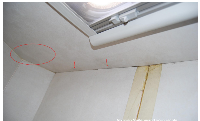
Durch Feuchtigkeit aufgequollene Alkovenseitenwand beim McLouis
