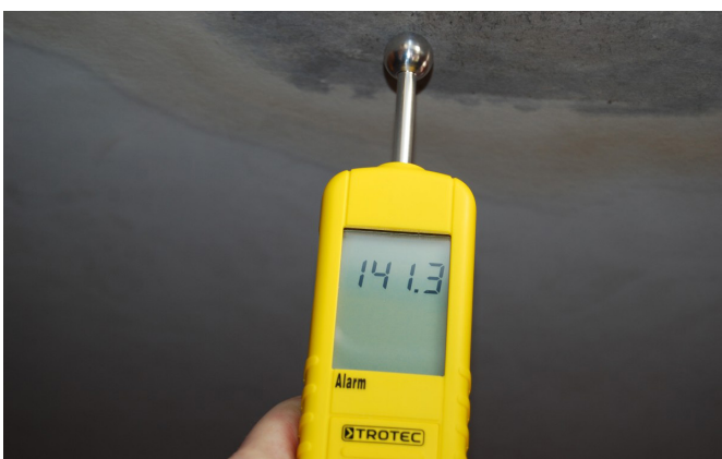
Wassereintritt am Dach. Ursache : Falsch montierte Dachklimaanlage!
