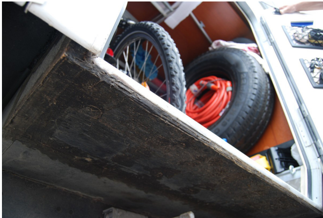
Beschädigter Garagenboden bei Hymer. Schlecht nachgebessert!
