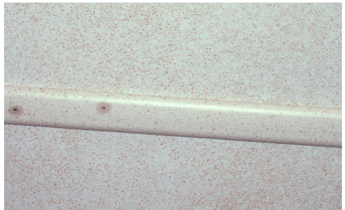
Wasserränder am Dachhimmel, sich auflösende Dachverkleidungen, Rostwasser aus Haltestiften und Tapetenverfärbungen von verschiedenen Herstellern.
