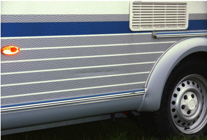
Typische Delle im Alublech mit Muschelstruktur Reparatur mit HBC-Methode
