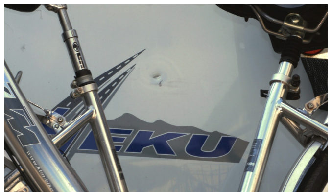
Heku, Delle in Heckwand, durch Fahrrad
