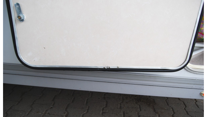
Adria, undichte Garagentür, Pfschreparatur an der Dichtungsleiste.
